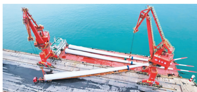
马村港三期散货码头完成琼北地区首次海上风电项目叶片装卸作业。 海南港航供图
